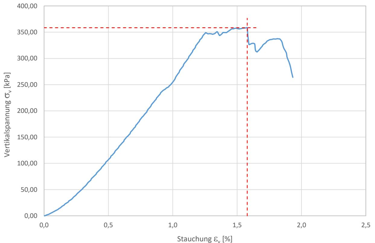
**Einaxialer Druckversuch** nach DIN EN ISO 17892-7
