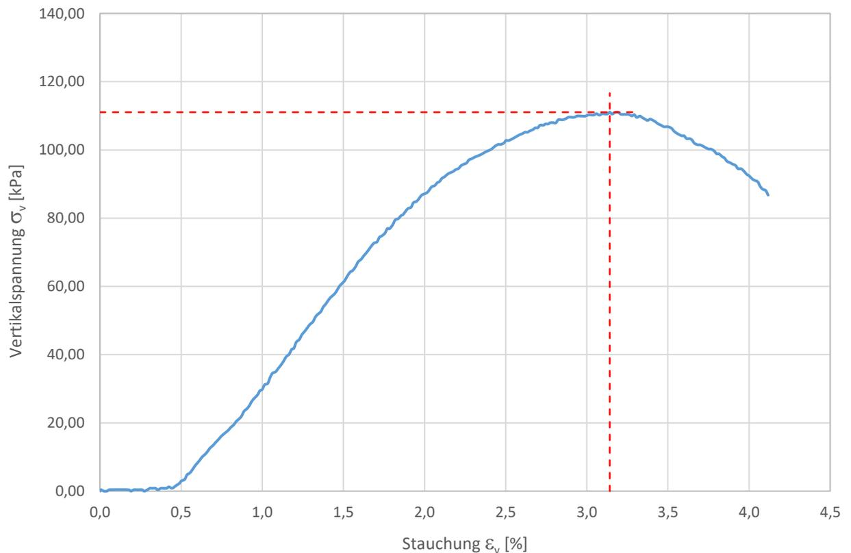
**Einaxialer Druckversuch** nach DIN EN ISO 17892-7
