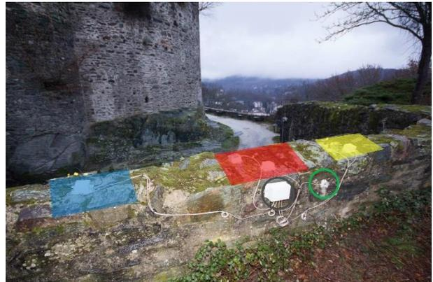
Abb. 8: Darstellung des zweiten Monitoringsystems, hierbei ist das Auslesegerät schwarz markiert, die Messung des Umgebungsklimas erfolgt über den Thermo-/Hygrosensor bei der grünen Markierung und die drei Messfelder mit jeweils drei Temperatursensoren sind in blau, rot und gelb markiert.
