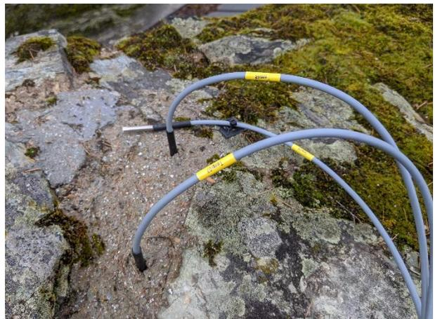
Abb. 18: Im dritten Feld (rechts, gelbe Markierung), sind die Temperatursensoren 7, 8 und 9 eingesetzt, auf dem Messbereich befindet sich kein Moos, ab dem 18.04.2019 befindet sich in diesem Feld das Substrat, der Messaufbau gleicht dem Aufbau des zweiten Monitoringsystems.
