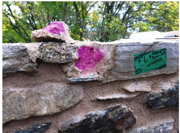
Abb. 19: Geringer, nur an der Oberfläche und an den Steinflanken über Mikrorisse erfolgter Carbonatisierungsfortschritt, Nachkontrolle im November 2019 im Musterfeld FL-Kalk mit 8er Überkorn (nach Standzeit von 3 Monaten; Foto: Burgenbüro Dr. Strickhausen).
