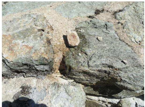
Abb. 21: Abgeschlossener Carbonatisierungsfortschritt, Nachkontrolle im Juli 2020 im Musterfeld Trass-Kalk (nach Standzeit von 34 Monaten).
