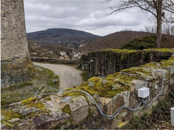
Abb. 13: Darstellung des dritten Monitoringsystems, nach der Beschädigung einiger Temperatursensoren durch die Einwirkung von Feuchtigkeit und Frost wurden alle Sensoren gegen ein deutlich widerstandsfähigeres Modell ausgetauscht.
