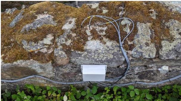
Abb. 20: Darstellung der Mauerkrone im zweiten Feld (mittig, rote Markierung in Abb. 8) am 04.07.2020, das Moos hat sich abgelöst, Sensor 6 auf der Oberfläche liegt vollständig frei, die gesteckten Sensoren 4 und 5 sind ebenfalls deutlich freigelegt.
