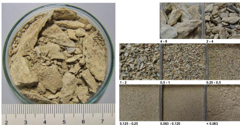
Abb. 3: Vergleichsprobe eines kalkig-lehmigen Innenputzmörtels (Gewölbe) vom Pulverturm auf der Burganlage Königstein mit schiefrigen Zuschlagskomponenten, (rechts: ausgesiebte Komponenten mit dazugehörigen Korndurchmessern).
