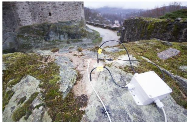
Abb. 12: Im dritten Feld (rechts, gelbe Markierung), sind die Temperatursensoren 7, 8 und 9 eingesetzt, dabei sind die Sensoren 7 und 8 in einem Bohrloch ca. 1 cm in der Fuge befestigt, während Sensor 9 auf der Oberfläche der Mauerkrone aufliegt, auf dem Messbereich befindet sich kein Moos, ab dem 18.04.2019 befindet sich in diesem Feld das Substrat.
