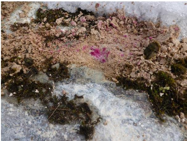
Abb. 18: Schäden im NHL-Mörtel nach/während erstem Winter 2017/2018. Der Nachweis der Carbonatisierung belegt diese nur für die Oberflächenschicht von 1-2 mm.
