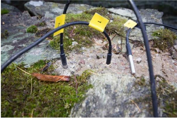
Abb. 9: Im ersten Feld (links, blaue Markierung), sind die Temperatursensoren 1, 2 und 3 eingesetzt, dabei sind die Sensoren 1 und 2 in einem Bohrloch ca. 1 cm in der Fuge befestigt, während Sensor 3 auf der Oberfläche der Mauerkrone aufliegt, auf dem Messbereich befindet sich kein Moos.
