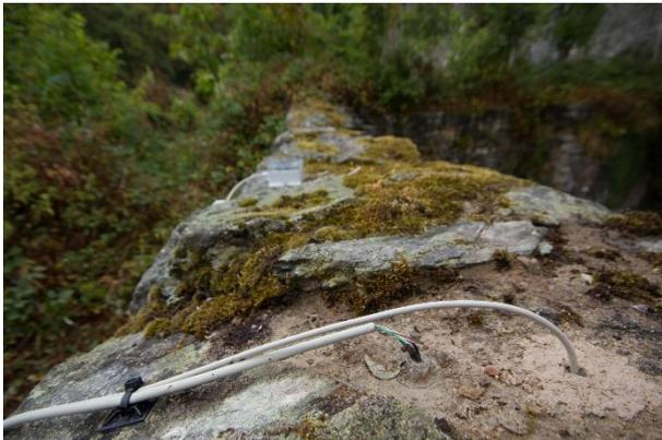
Abb. 7: Detailaufnahme der eingesetzten Messlanzen des ersten Monitoringsystems ohne aufgebrachtes Substrat.
