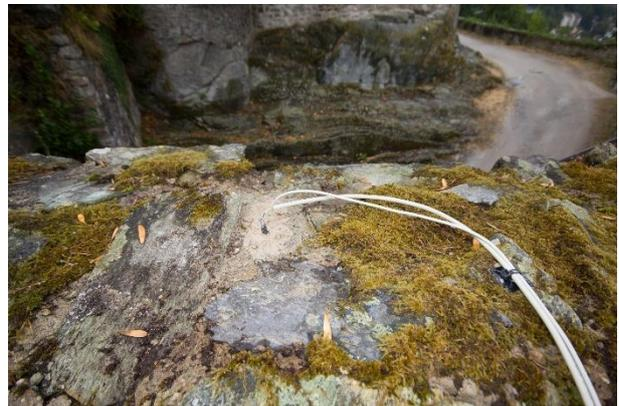
Abb. 6: Detailaufnahme der eingesetzten Messlanzen des ersten Monitoringsystems.
