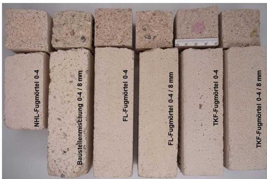
Abb. 25: Labortechnisch hergestellte Mörtelprismen (4x4x16 cm) der relevanten sechs Rezepturen.
