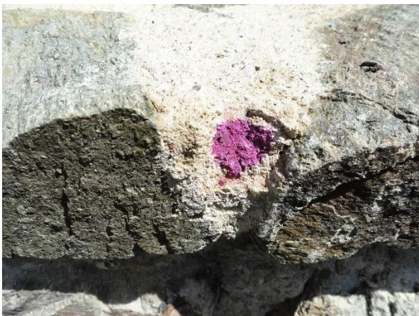
Abb. 20: Erreichter Carbonatisierungsfortschritt von 6-7 mm, Nachkontrolle im Juli 2020 im Musterfeld Baustellenmischung (nach Standzeit von 11 Monaten).
