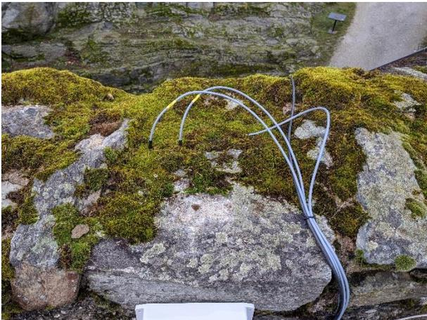
Abb. 15: Im zweiten Feld (mittig, rote Markierung), sind die Temperatursensoren 4, 5 und 6 eingesetzt, auf dem Messbereich befindet sich Moos, der Messaufbau gleicht dem Aufbau des zweiten Monitoringsystems.
