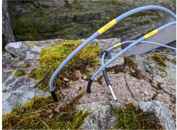
Abb. 14: Im ersten Feld (links, blaue Markierung), sind die Temperatursensoren 1, 2 und 3 eingesetzt, auf dem Messbereich befindet sich kein Moos, der Messaufbau gleicht dem Aufbau des zweiten Monitoringsystems.
