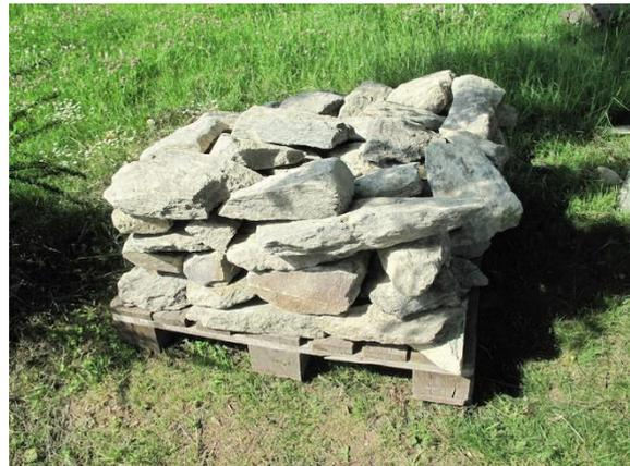
Abb. 12: Frisches Steinbruchmaterial aus Serizit-Gneis zwecks Ergänzung von Fehlstellen (Foto: Burgenbüro Dr. Strickhausen).
